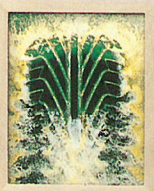
Michelin Pilot Sport, visualisation sous plaque de verre de l'adhérence du pneu sur forte hauteur d'eau.
