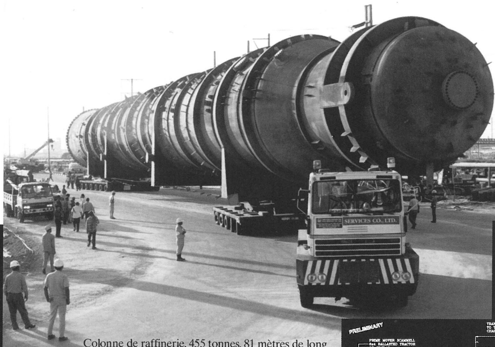
Colonne de raffinerie, 455 tonnes, 81 mètres de long
